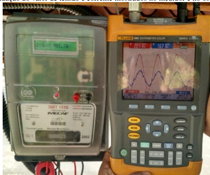
Figura 3.6 – Validação do valor de tensão e corrente mostrados no medidor e no osciloscópio portátil.
