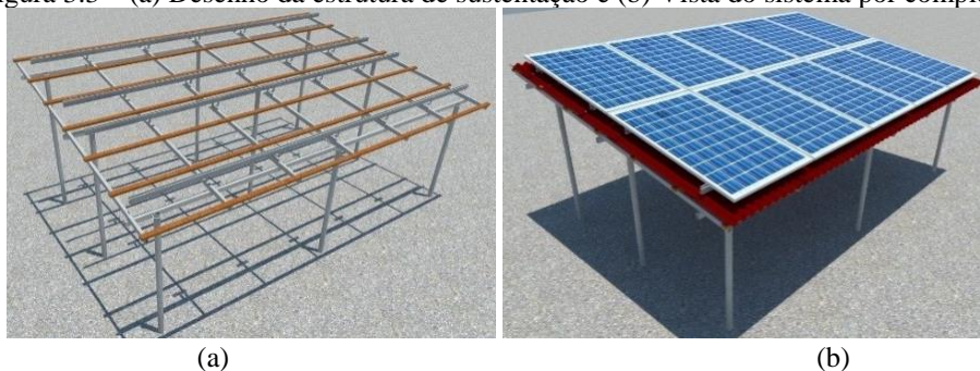
Figura 3.3 – (a) Desenho da estrutura de sustentação e (b) Vista do sistema por completo.
